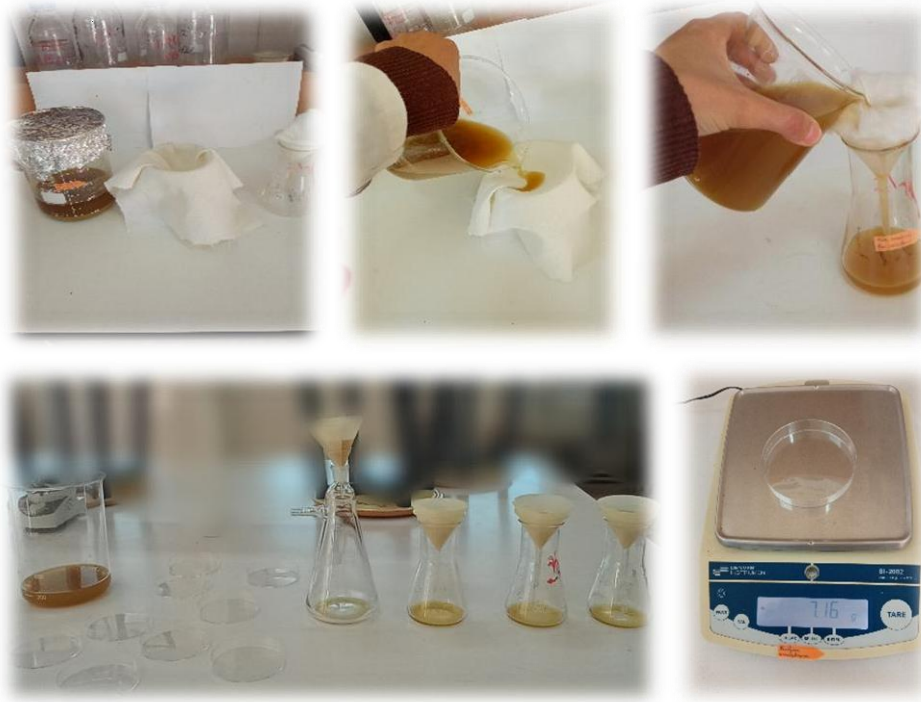
Figure 10: Filtration l'extrait brute de décoction de les parties aériennes de Ruta montana
